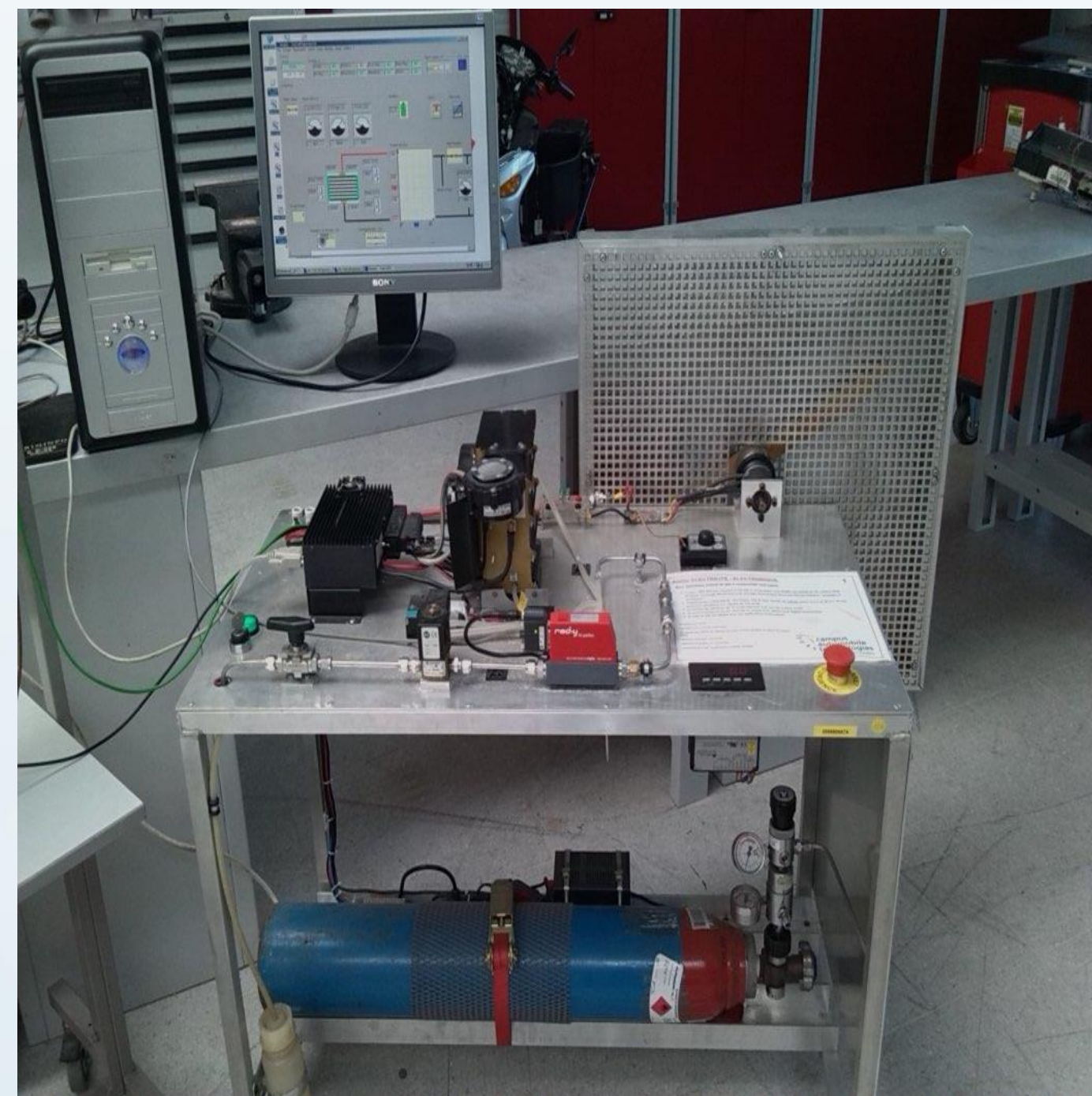
Stanowisko testowe ogniw paliwowych przy pomocy zbiornika ciśnieniowego B10-200 barów
